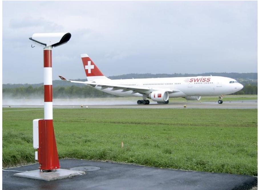
O Transmissômetro Vaisala LT31 permite medição de linha de base única, de forma precisa e confiável, para aeroportos de categoria CATIIb.
